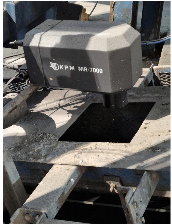
Misura di umidità in sabbia quarzifera
